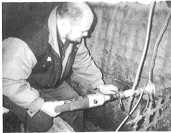
Fig. 12. Slutkontrol med den opnåede realkalisering eller chloridudtrækning sker ved analyse af udborede kerner fra konstruktionen. Det sker ved prøvning med phenolphthalein eller bestemmelse af det opnåede chloridprofil.
